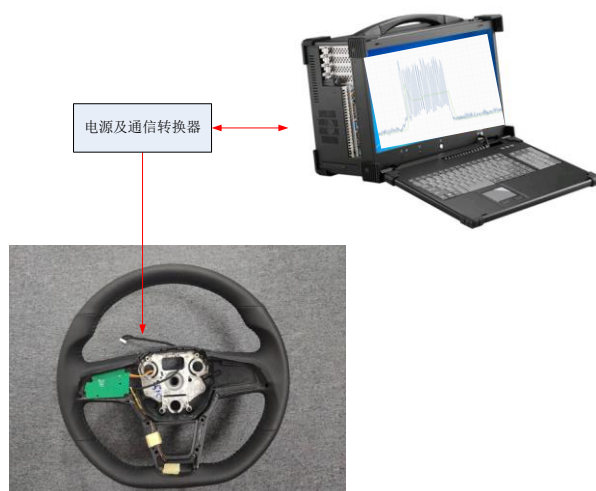
图 3.7 AS8579 DEMO 测试平台搭建
