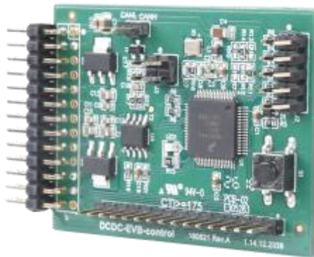
图 1.3 DCDC EVB CONTROL 主控板
