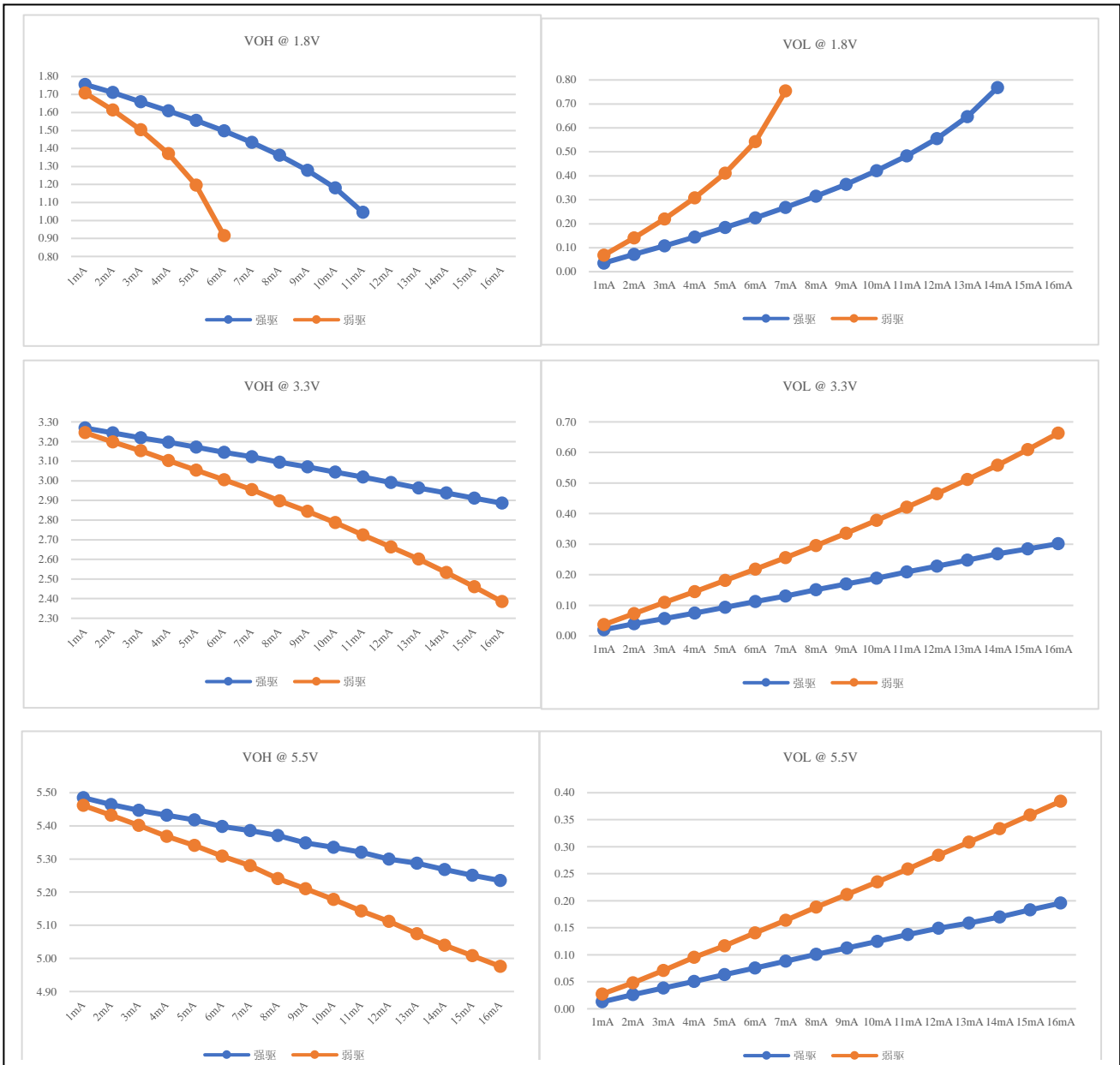
图 7-2 输出端口 VOH/VOL 实测曲线
