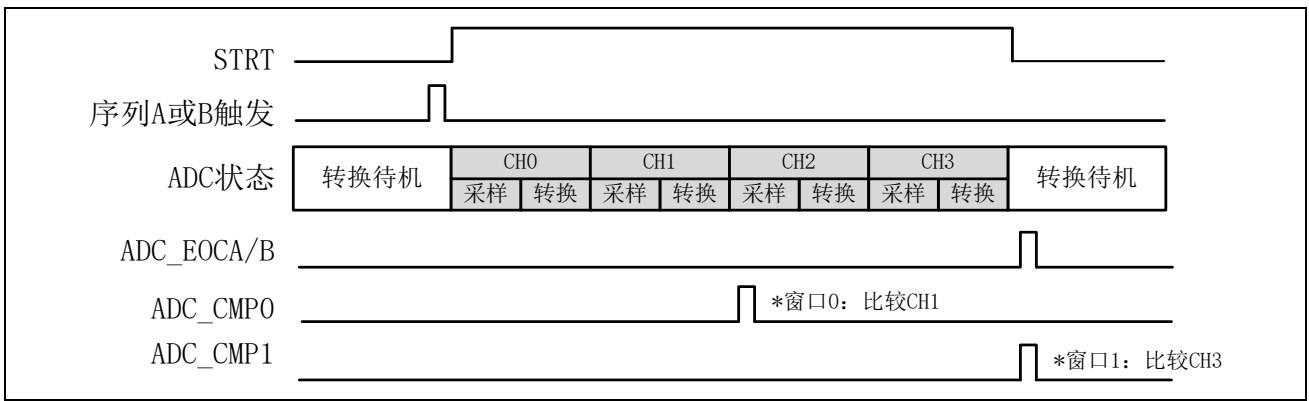
图 16-11 ADC 中断和事件输出时序
