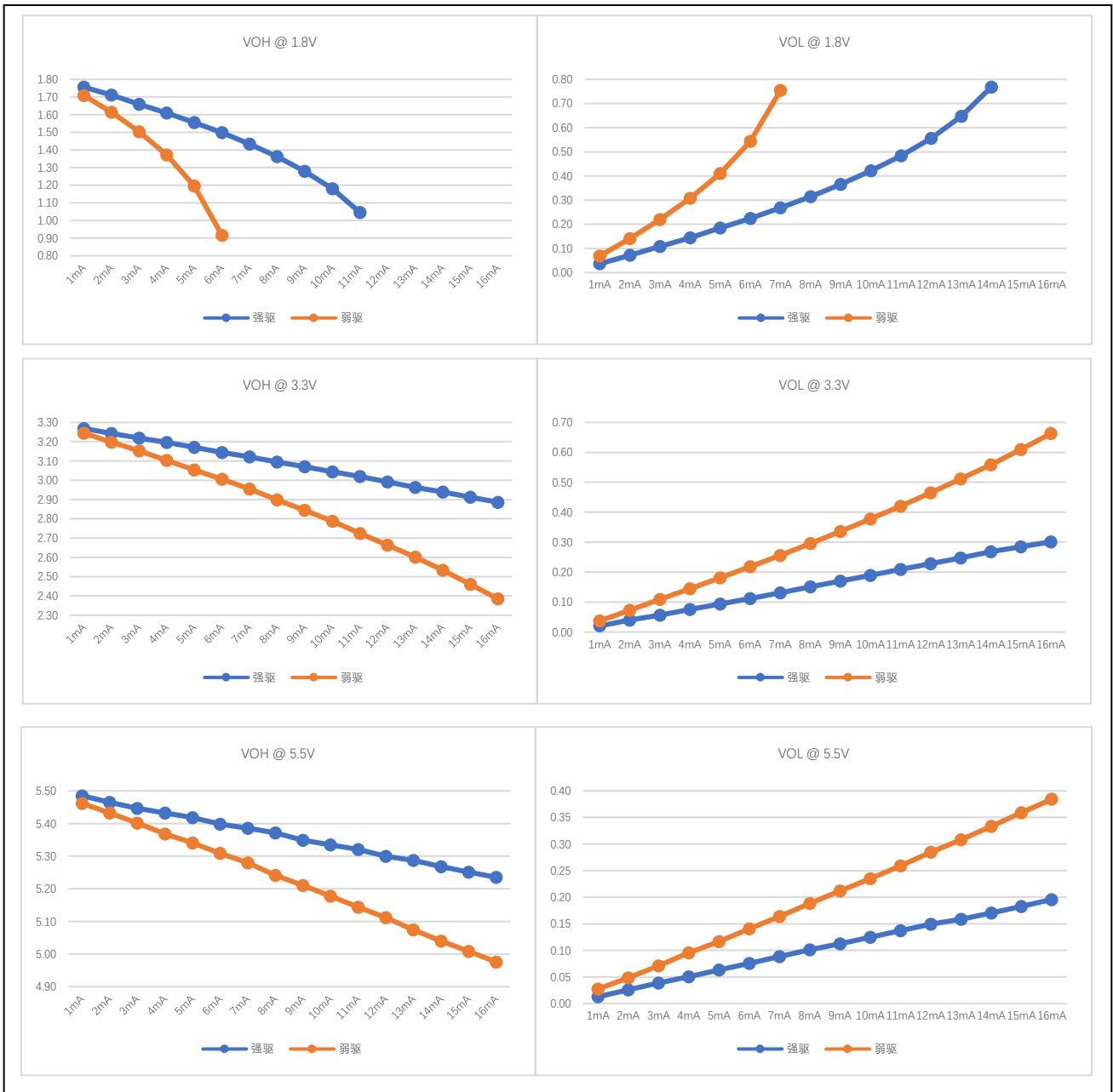
图 7-2 输出端口 VOH/VOL 实测曲线
