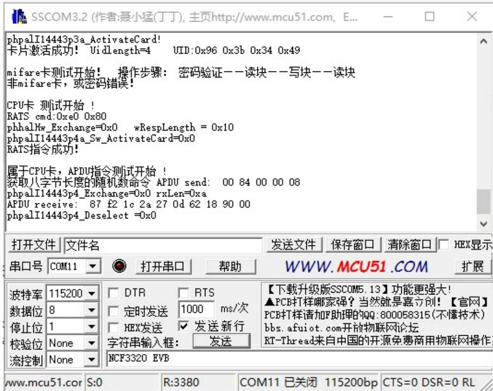
图 3.11 CPU 卡测试
