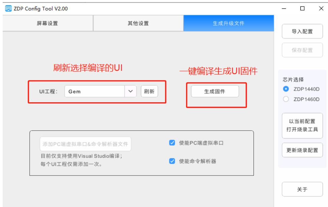
图 1.6 上位机一键编译生成 UI 固件
