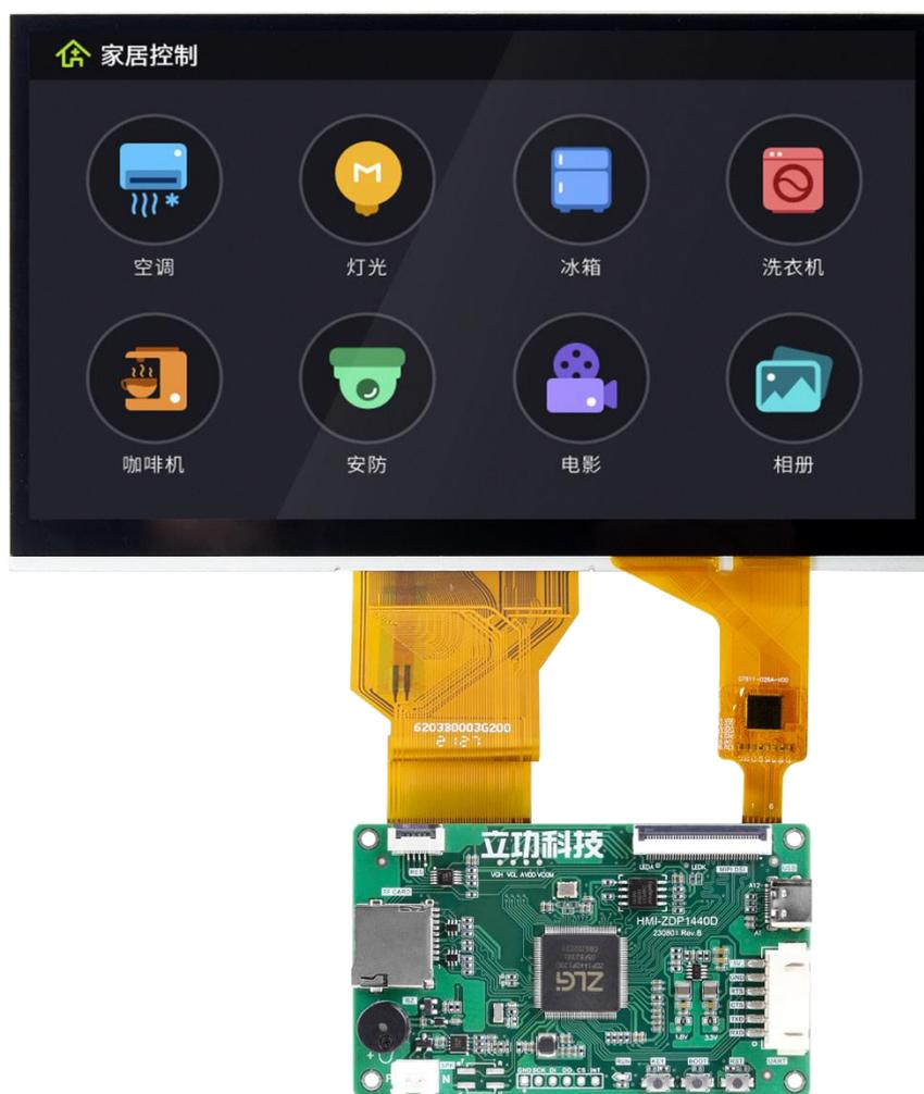
图 3.1 HMI-ZDP14X0 显示评估套件实物图
