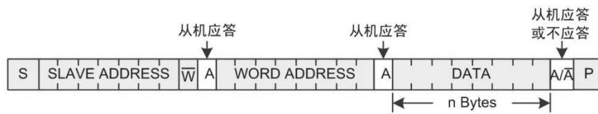
图 3.5 主机向从机发送数据示意图
